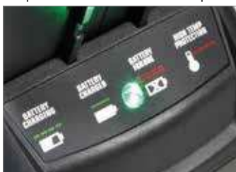
LED indicador com legenda para identificar imediatamente o estado da bateria.
