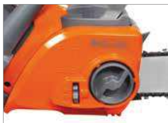
Regulação da corrente sem ferramentas.
